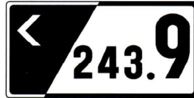
01b – Demarcação hectométrica da via – IC
