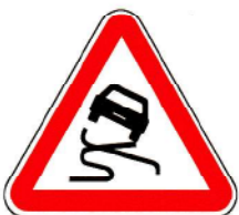
A5 – Pavimento escorregadio
